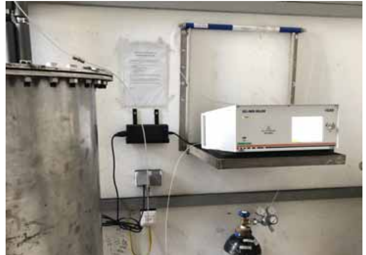
Abbildung 3: GC-IMS-SILOX on-site in einer Deponiegasanlage
